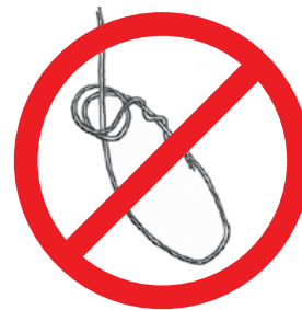
Figure 2 – Double nœud coulant traditionnel interdit
